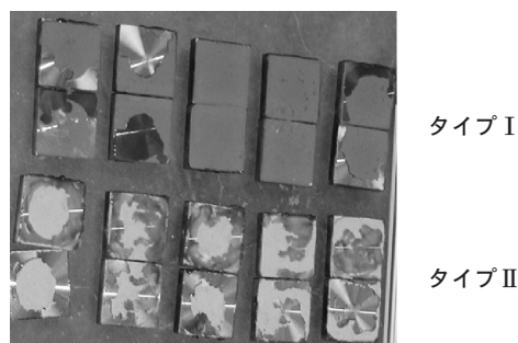
写真-2 予備試験破断状況
