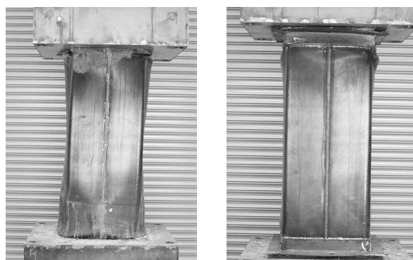
写真－１ 試験体最終状況
