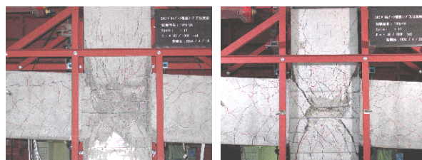
試験体破壊状況 (最終) 写真
