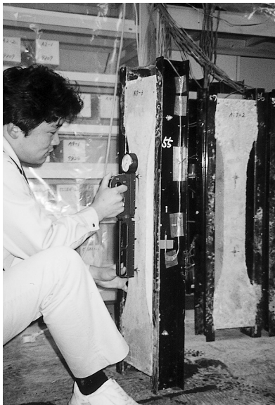
写真-2 拘束ひび割れ試験の状況
