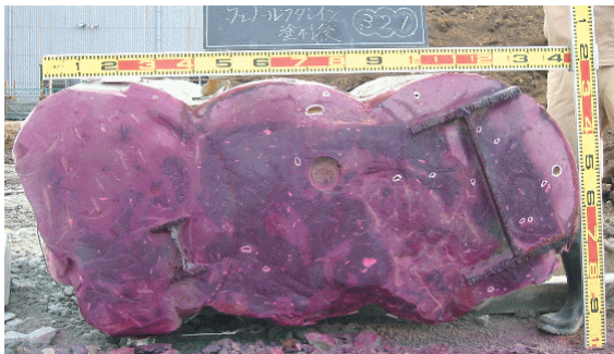
写真-2 土塊混入量調査状況
