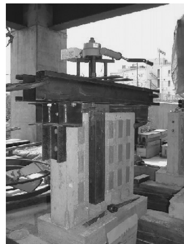
写真－4 せん断試験状況
