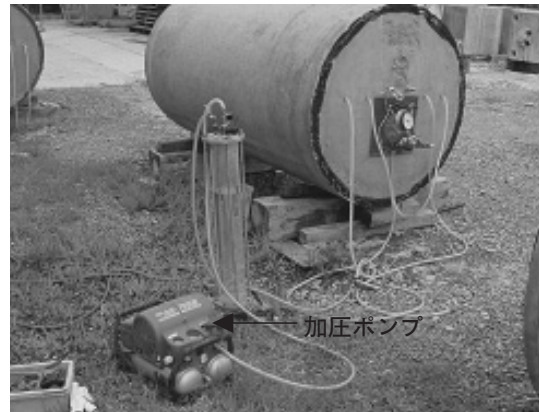
写真-4 注水試験状況
