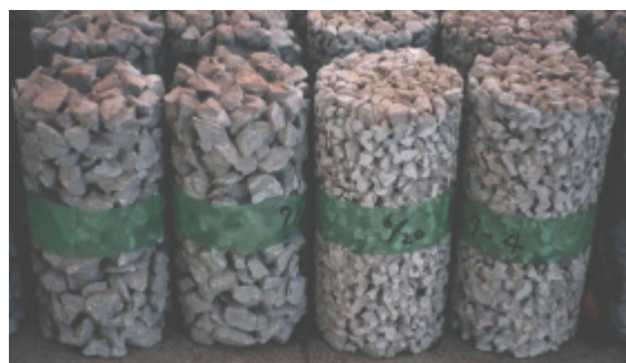
再生碎石を用いたポーラスコンクリート
