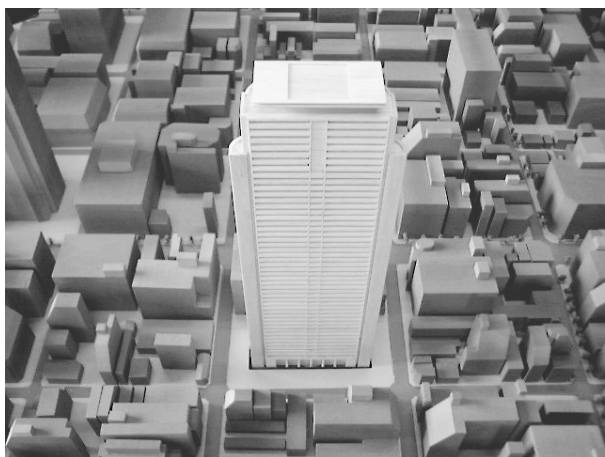
写真－2 実験模型（空気力実験用模型）
