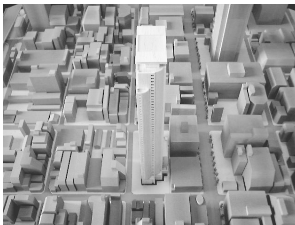
写真－3 実験模型（空気力実験用模型）
