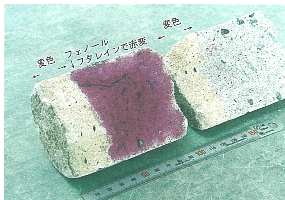
写真－3 コア3（中性化深さ測定後）
