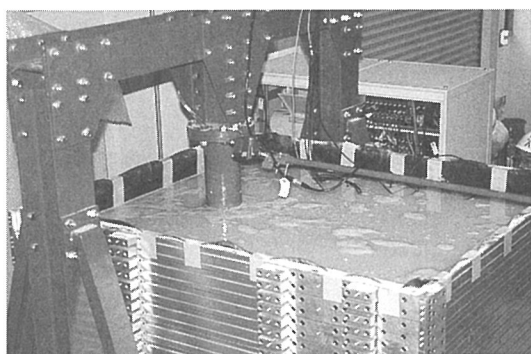
写真一3 加振後の土槽（液状化後）
