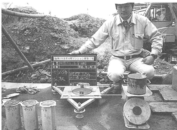
写真-4 フレッシュ時の性状試験
