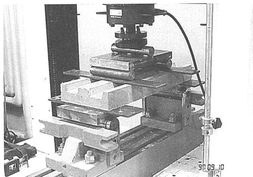
写真－7 試験体の曲げ強度試験（Type－2）
