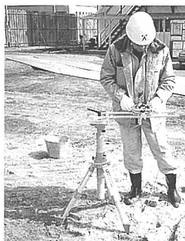
写真－４ 受光器台の設置状況
