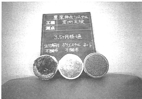
写真-6 3.5カ月経過後の試験体 (室内養生)
