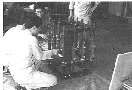
写真-2 引張試験体の製作状況
