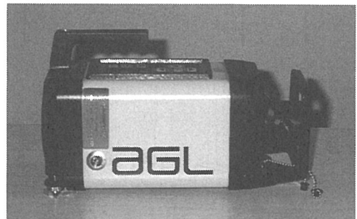
写真-1 回転レーザー
