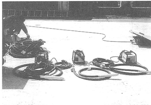
マイコン制御のマグネット型バイブレーター
