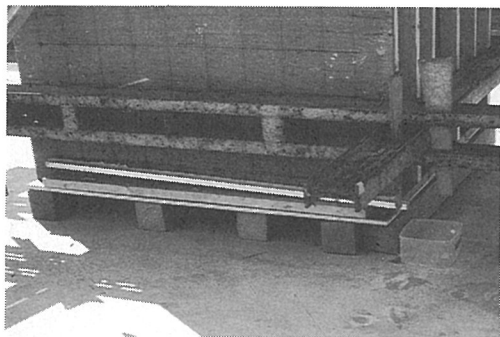
写真-2 排水量測定装置
