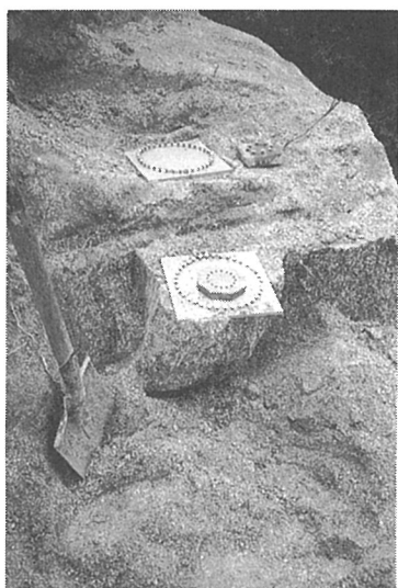
写真-2 釘打ち法による不攪乱試料の採取
