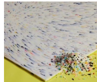
廃プラスチックを板材にアップサイクル （オープンリサイクル）
