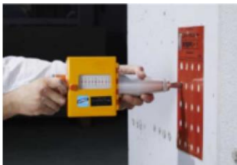
リバウンドハンマーによる表面強度推定
