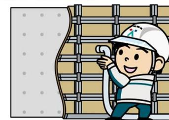
●CCB工法、PRS(ポラスレジンサンド)目地充填工法
