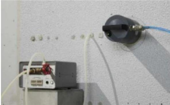
ダブルチャンバー法での測定状況
