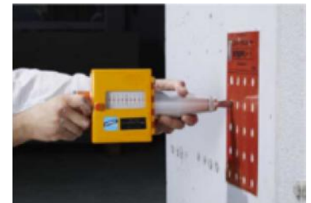
リバウンドハンマーによる表面強度推定
