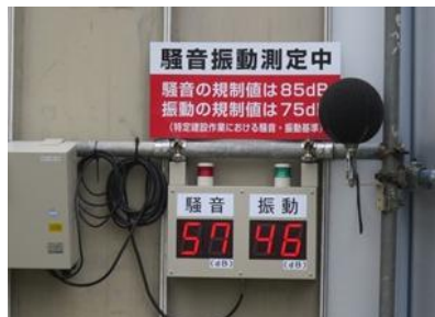
作業所の騒音・振動の管理
