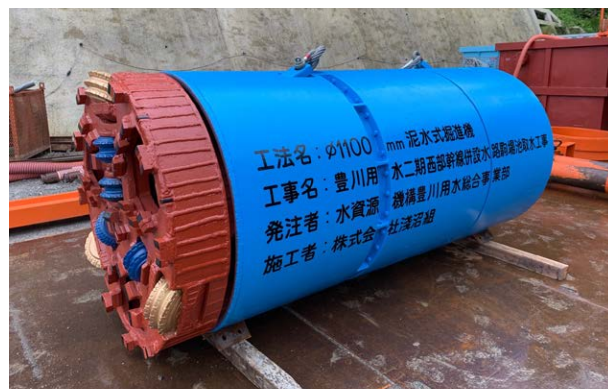
\phi 1100\text{mm} 泥水式推進機
