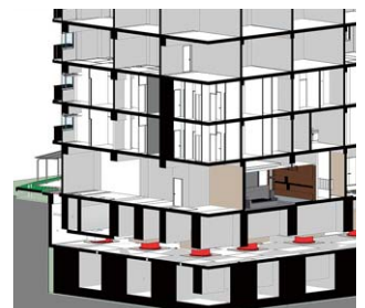
モデル切断状況 作成したモデルを自由な位置で切断し確認することが可能となり、空間把握が容易となります。
