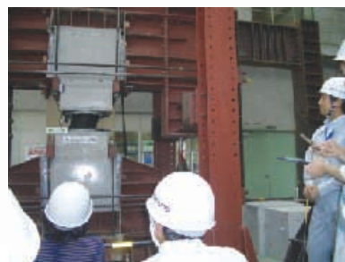
■免震装置の加力実験の状況
