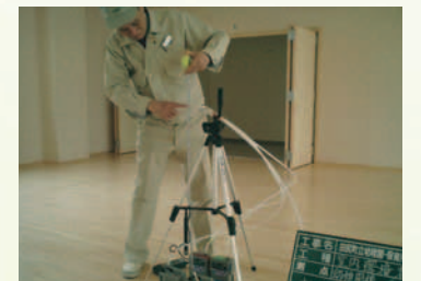
【室内化学物質濃度の測定状況】
