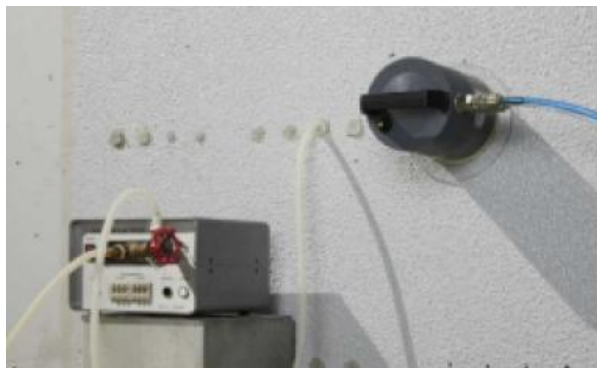
ダブルチャンバー法での測定状況
