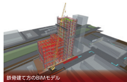
鉄骨建て方のBIMモデル
